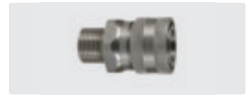
acoplador : rosca m. acero inox. cône 60°. máx. 250 bar / 150 °C
