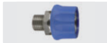
acoplador : rosca m. acero inox. cône 60°. máx. 250 bar / 150 °C
